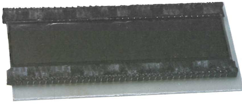
Circuito base del contatore LCD completo di display a cristalli liquidi a realizzazione ultimata.
